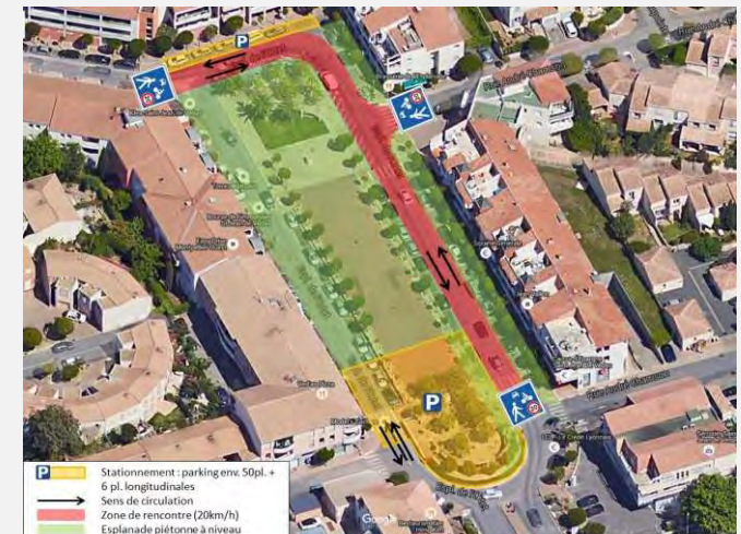
Proposition de requalification d'espace publique en zone de rencontre – PLD de St Jean de Védas Cergy-Pontoise
