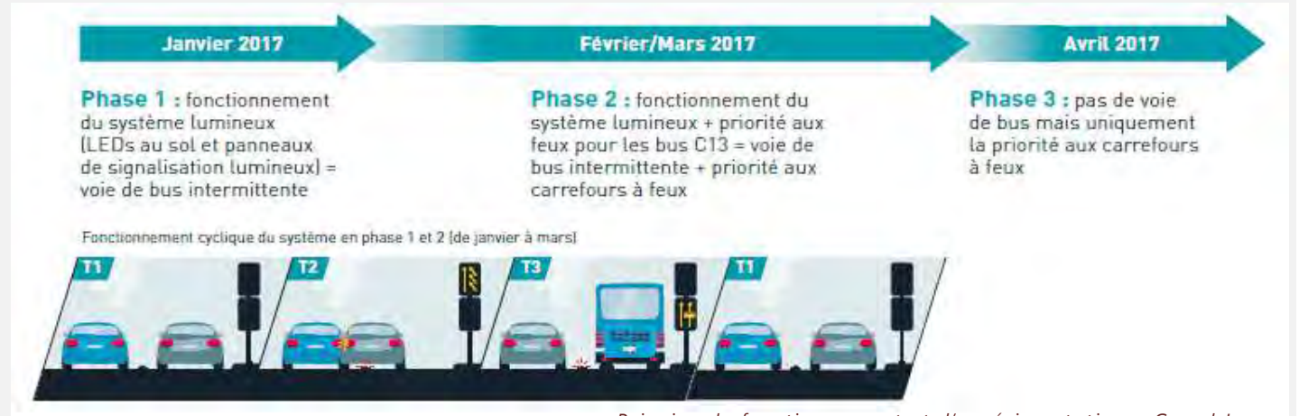
Principe de fonctionnement et d'expérimentation – Grand Lyon
